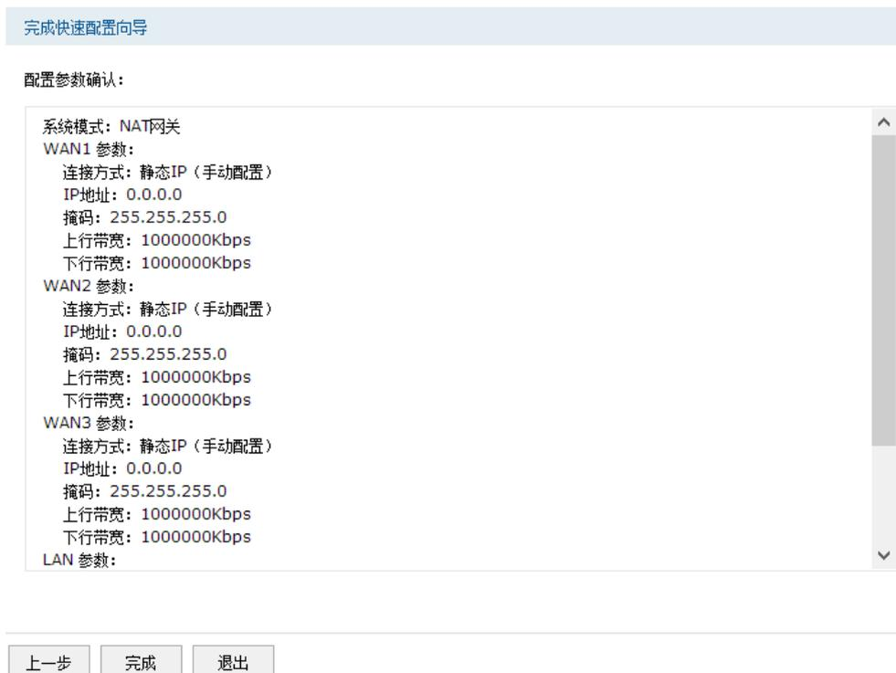
图 4-7 快速配置设置界面-完成快速配置向导
